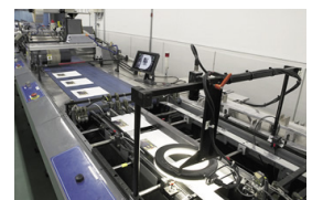
薄型サンプルを自動添付・封入する「アタッチャーシステム」
