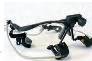
紙面を見る視線の動きを捉える「アイトラッキング」用計測システム
