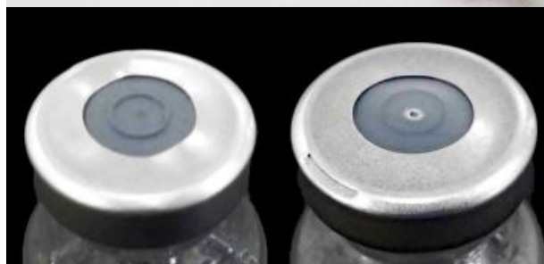
(上)針刺し検知フィルムの使用製品イメージ (下)針を刺した後の容器蓋の状態 針刺し検知フィルムなし(左)、針刺し検知フィルムあり(右)
