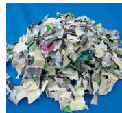
廃カードを粉碎処理
