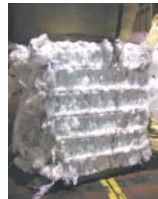
使用後圧縮したストレッチフィルム（五霞工場）
